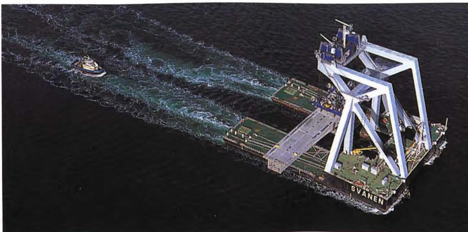
Sobre estas líneas, fotografía del método utilizado para transportar sobre el mar las piezas del puente sobre el Flinten. A la derecha, en las gráficas A1-A5, proceso de ensamblaje de los soportes del puente elevado. Abajo (gráficos B1-B4), secuencia de la construcción de los dos puentes de acceso.
